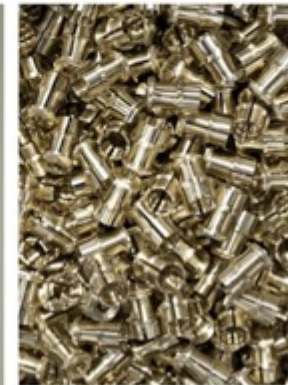
Massevis af CNC-drejede klemmebesætninger til konnektorer. En konnektor er det stik, der forbinder tv-kablet med selve tv- eller internetapparatet.
