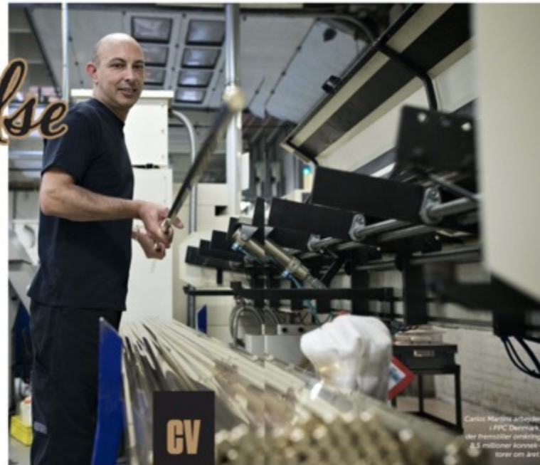
Massevis af CNC-drejede klemmebesætninger til konnektorer. En konnektor er det stik, der forbinder tv-kablet med selve tv- eller internetapparatet.
